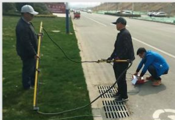
采空区瞬变电磁现场探测
